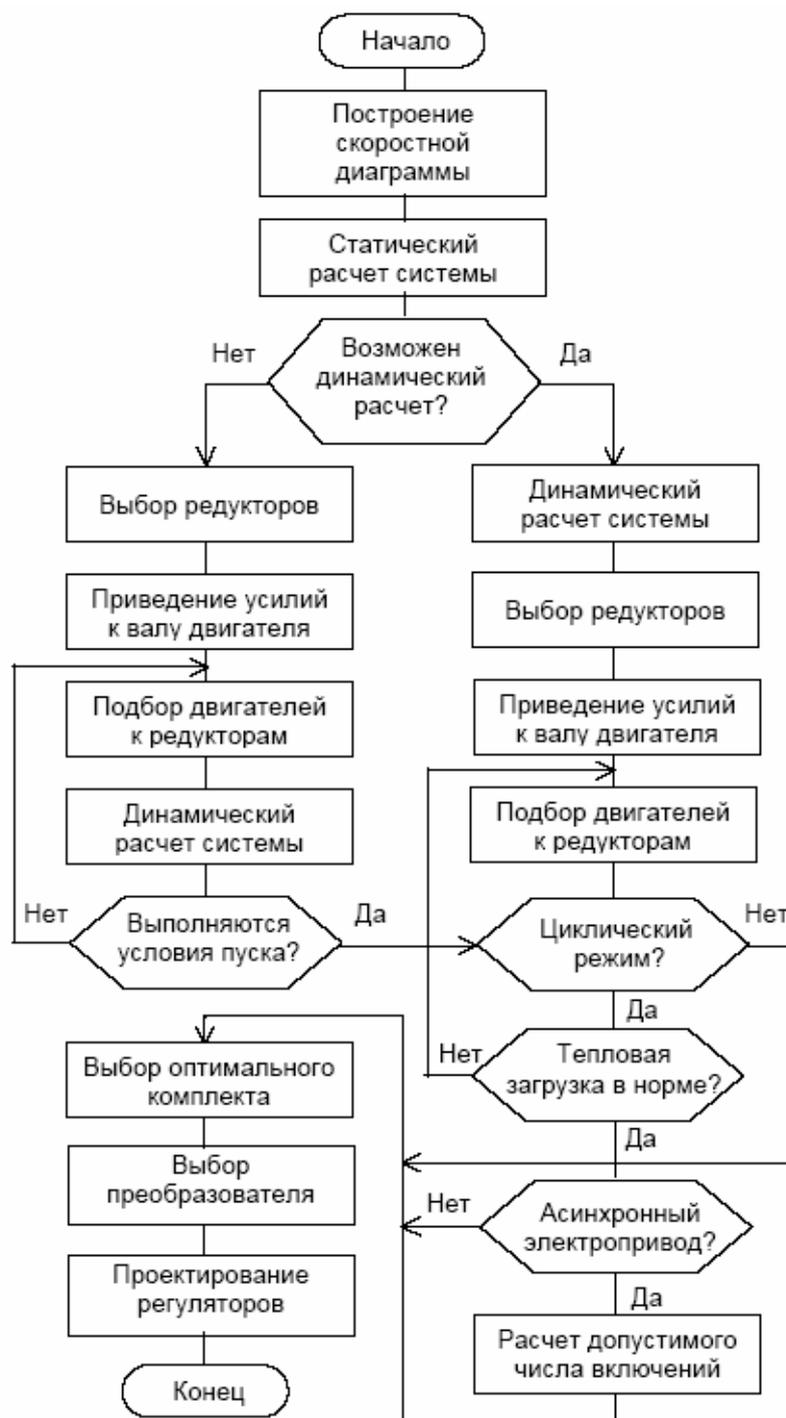
Рис. 3. Примерный алгоритм проектирования электропривода по работам Водовозова В.М.
