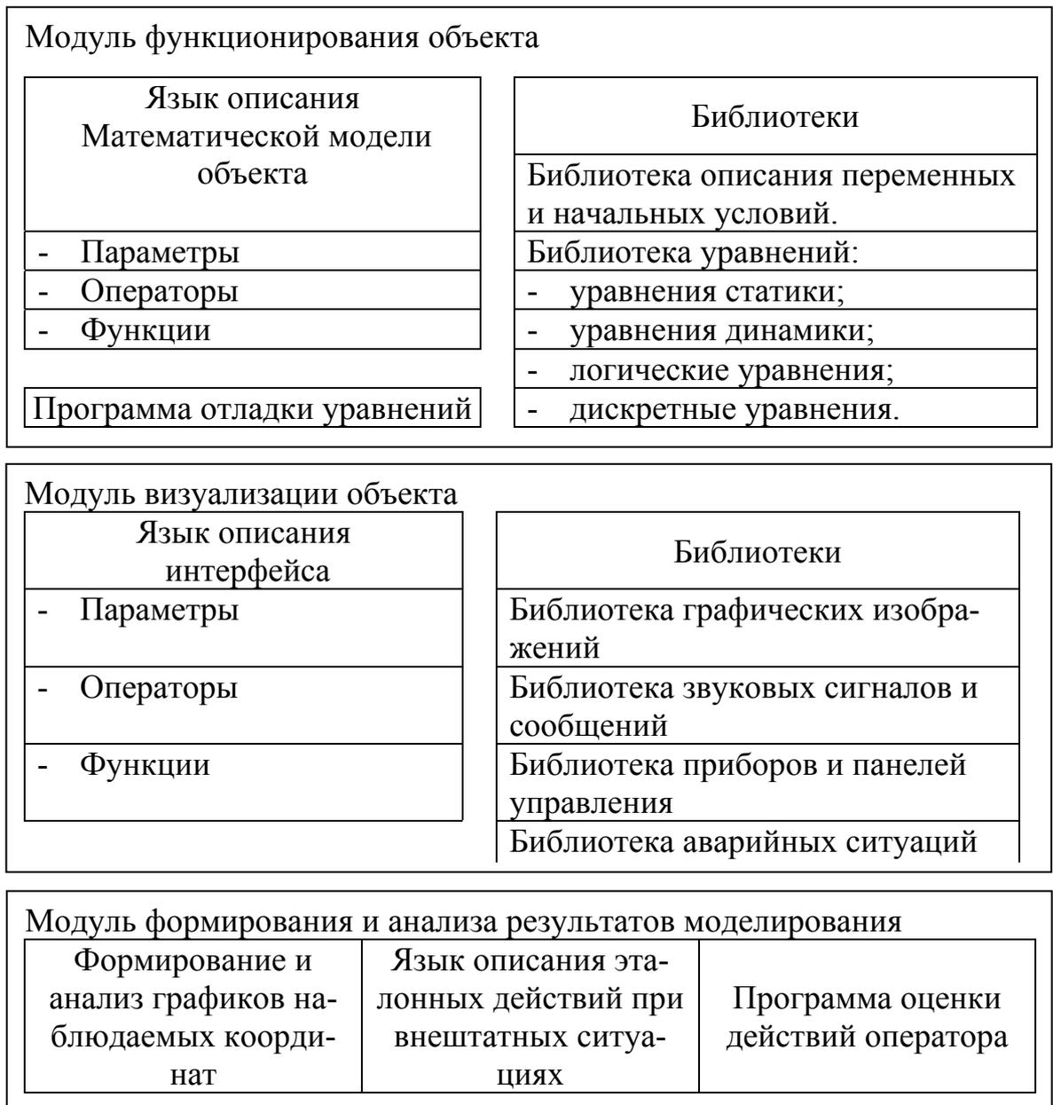
Рис. 1. Структура программного комплекса эмуляции функционирования промышленного объекта
